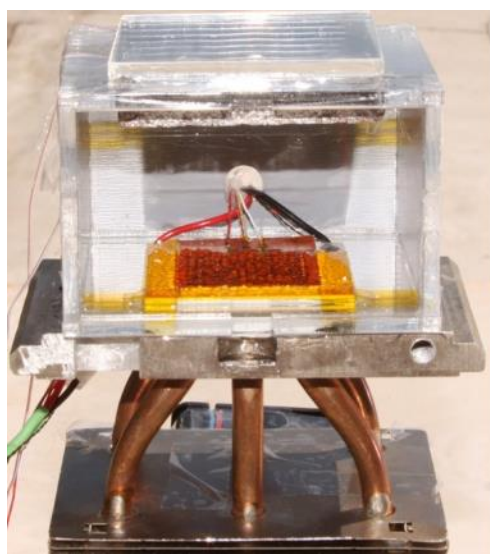
图 4. 利用金属有机骨架聚合物制备的空气水分收集装置原型
